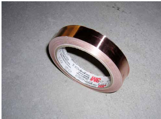
2 Feuillard de cuivre (auto-adhésif) pour la réalisation d'un revêtement conducteur.
